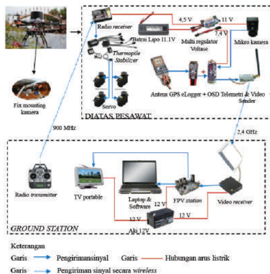
Gambar 2. Instrumentasi pemotretan UAV
