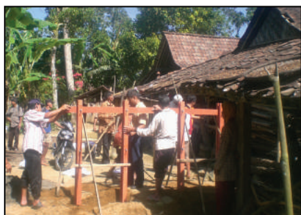
Gambar 5. Pelatihan pemasangan ektensometer sederhana dari kayu untuk pemantauan gerakan tanah di Desa Tangguh Sidoharjo, Samigaluh, Kulon Progo (foto: Hariyadi Djamal 13-6-2012)
